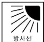
**태양열 복사:** EN 60068-2-5 (2011). 태양열 시험: 분위기 온도 55°C에서 복사 조도 1120 W/m<sup>2</sup>로 24시간 동안 자외선을 쬐는 시험.
