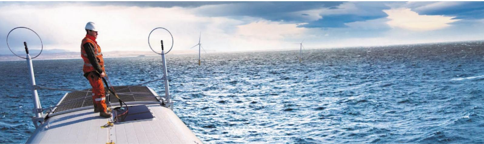
신뢰할 수 있는 풍속 측정은 다수의 이유로 인해 터빈에 있어 매우 중요합니다. 낮은 풍속에서는 에너지가 충분치 않아 터빈 가동이 정당화되지 않으며, 가동을 중지하기에는 비효율성이 좋지 않습니다. 하지만 높은 풍속에서는 안전을 위해 터빈을 중단해야 합니다. 두 풍속 사이에서, 터빈은 일정한 풍속 데이터를 받아야 계속 작동하며 전력을 생산하고 풍력발전소 운영자의 수입을 올립니다. 데이터 손실이 일어나는 경우 즉각적으로 풍력 터빈을 중단해야 합니다. 풍속 측정은 또한 블레이드 피치 각도를 결정하고 레퍼런스 전력 커브 예상치를 제공하는 데 사용됩니다.
