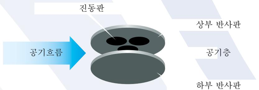
센서는 측정 공동 내부의 초음파 신호 공진에 그 작동 원리를 두고 있습니다. 공기가 공동을 지나가며 발생하는 초음파 신호의 위상차를 측정함으로써 공기 흐름을 감지합니다. 센서 내부에는 3개의 변환기가 정삼각형 형태로 설치되어 있습니다. 송신 변환기 및 수신 변환기 짝간의 실제 위상의 차이로 변환기 짝의 측 방향 공기 흐름에 대한 정보를 알아내고, 3쌍을 모두 측정하게 되면 변환기에 의해 형성되는 삼각형의 각 변 방향으로의 공기흐름의 성분 벡터를 결정할 수 있습니다. 이 벡터들을 결합하면 종합적인 풍속과 풍향을 알 수 있게 됩니다. 이러한 성분벡터들을 합치면 전체 속도와 방향을 알 수 있습니다. 이러한 계산을 위해 각 측정 단계마다 복잡한 신호 처리 및 데이터 분석을 사용하고 있습니다. 센서에는 온도, 압력 및 습도 변화에 대한 원천적 보정 기능이 내장되어 있습니다. 작은 공간에서 강력하게 공진된 음파가 쉽게 측정 가능한 큰 신호를 만들어냅니다.
